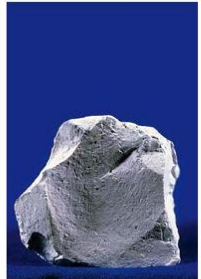
高岭土是一种白色矿物，被用于造纸工业中，也可用作塑料的填料和用于制造瓷器。高岭土的主要成分是高岭石  $\text{Al}_2\text{Si}_2\text{O}_5(\text{OH})_4$ ，该物质在  $450^\circ\text{C}$  与  $600^\circ\text{C}$  之间脱羟基。这是 TGA 曲线中发生重量损失的原因。示例显示了三种具有不同高岭石含量的高岭土样品的测量结果。高岭土 A 的 DSC 曲线在大约  $575^\circ\text{C}$  时出现一个小峰。它是  $\alpha$  石英向  $\beta$  石英固固转变的特征。在大约  $1000^\circ\text{C}$  时的放热峰是由于莫来石的形成所致。
